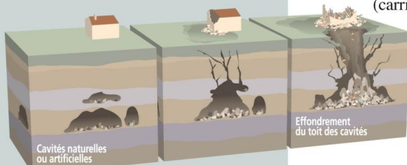
La décompression des roches est à l'origine de l'effondrement du toit des cavités souterraines.
